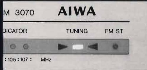
Balken - LEDs zur Verfügung. Unpräzise Sendereinstellungen werden automatisch durch rote Pfeilfelder angezeigt.
