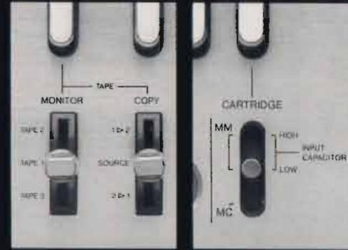
Für Tape 1 und Tape 2 besteht außerdem eine Kopiermöglichkeit untereinander (1  $\rightarrow$  2, 2  $\rightarrow$  1) mit einer Monitoreinrichtung, die auch die Buchse Tape 3 einschließt.
